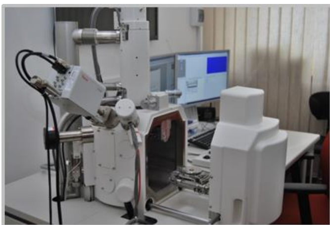
Aparatura do syntezy i badań otrzymanych materiałów zeolitowych (mikroskop SEM/EDS, analizator G3S-ID)
