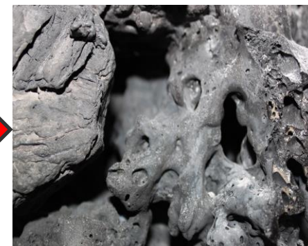
Model rozwoju kawerny w procesie UCG oraz obraz kawerny poreakcyjnej z eksperymentów zgazowania w Centrum Czystych Technologii Węglowych GIG
