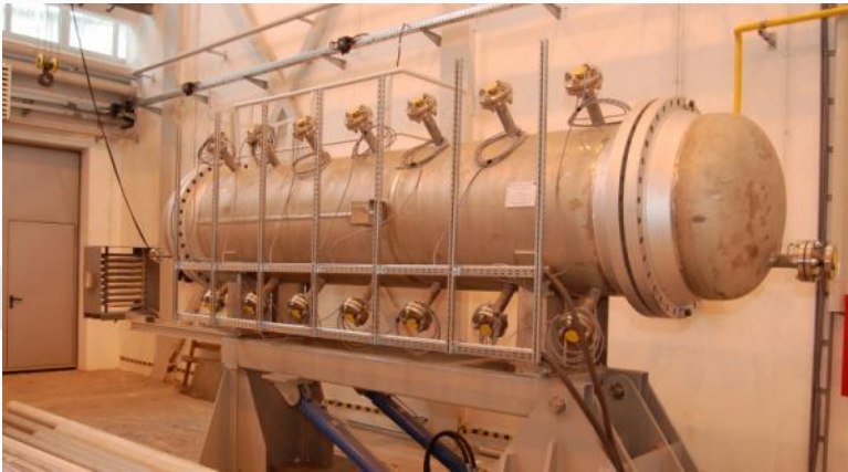
Reaktor Ciśnieniowy do symulacji procesu podziemnego zgazowania węgla
