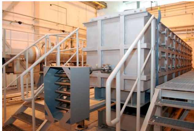
Reaktor bezciśnieniowy do symulacji procesu podziemnego zgazowania węgla
